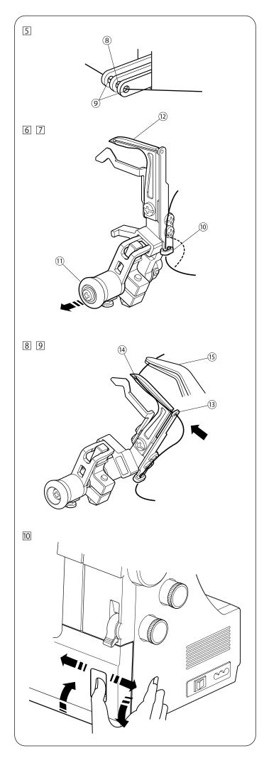
Поверните маховое колесо на себя несколько раз, чтобы выровнять глазок рычага нитеводителя петлителя с направляющими отверстиями.
