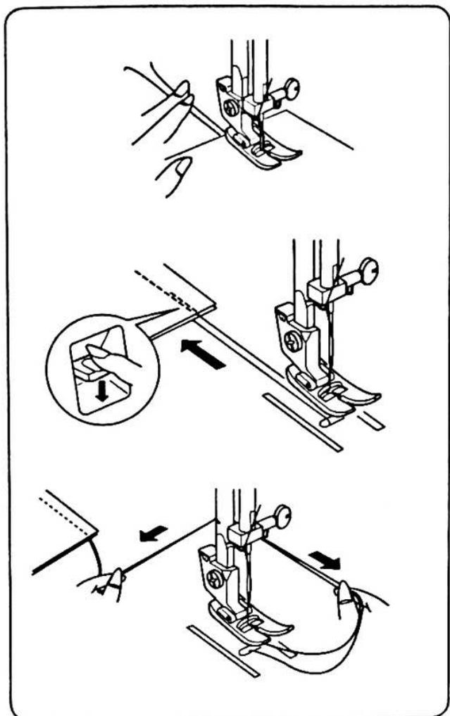
1 Поднимите прижимную лапку и расположите ткань в соответствии с направляющими линиями на игольной пластине. Опустите иглу в ткань. Опустите прижимную лапку и отведите нити назад. Нажмите на ножную педаль. Слегка только направляйте ткань вдоль линий на игольной пластине, ткань должна сама проходить под лапку.
