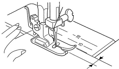
Цифры на игольной пластине определяют расстоянии между центральной позицией иглы и линией.
