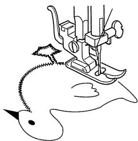
Наметайте (или приклейте утюгом и флизелином) аппликацию на ткань. Шейте вокруг аппликации так, чтобы стежки ложились по внешнему краю аппликации. При шитье углов опускайте иглу в ткань, поднимайте лапку и поворачивайте ткань вправо или влево.
