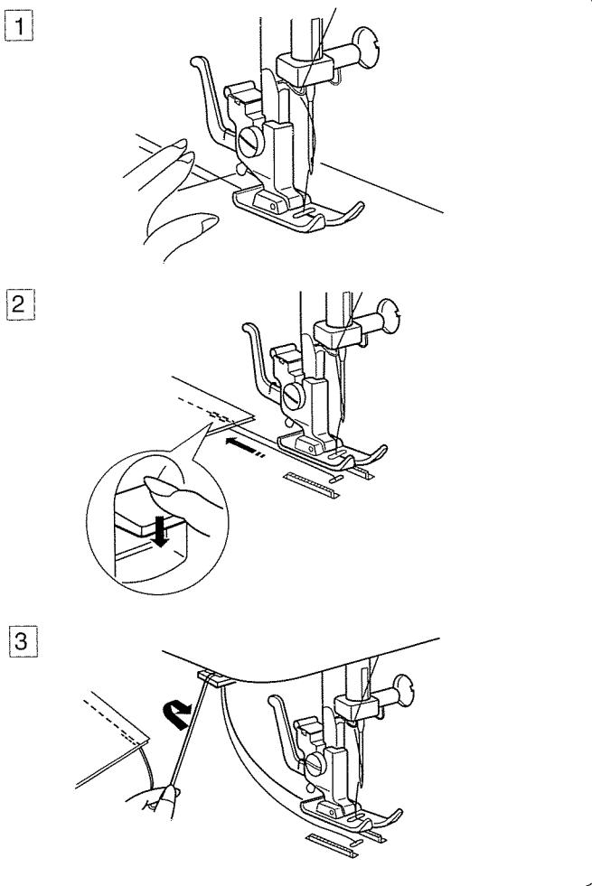
**1** Поднимите прижимную лапку и расположите ткань в соответствии с направительными линиями на игольной пластине.
