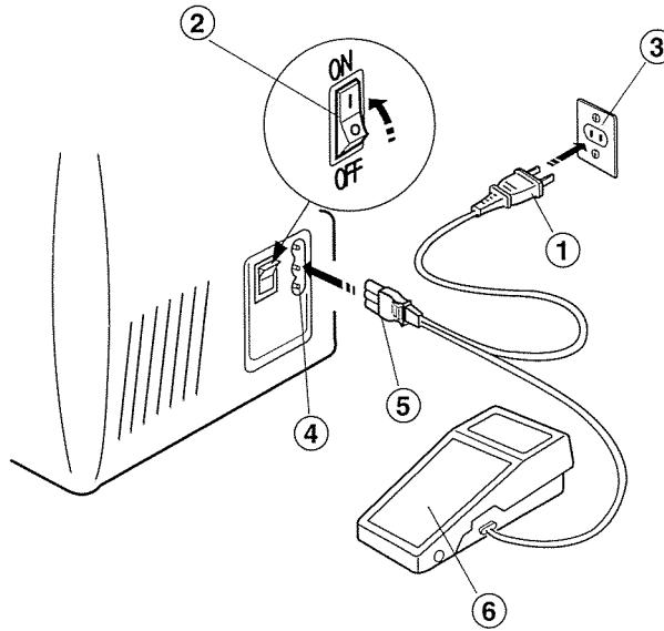
Перед подключением шнура, убедитесь, что напряжение и частота в Вашей сети соответствуют напряжению и частоте, указанным на машине.
