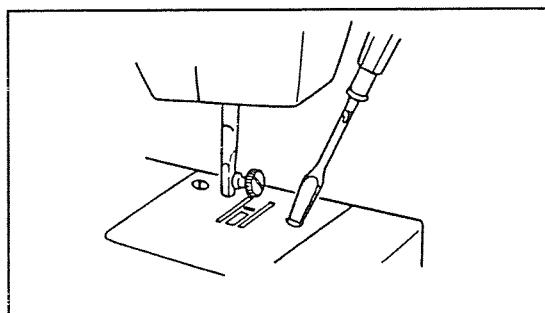
Снять иглу и нажимную лапку.
