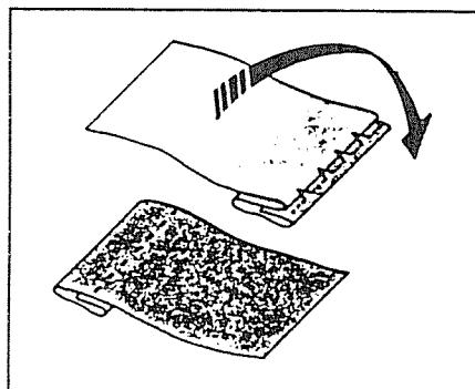
Поднять нажимную лапку и разместить ткань под лапкой, чтобы первый сгиб опирался на стенку приспособления. Опустить лапку и выполнить зигзагообразную строчку осторожно так, чтобы узкие стежки строчки разместились на кромке, а широкие стежки выполнены на сложенной части ткани. Во время работы надо следить за тем, чтобы складка первого сгиба проходила по стенке приспособления.
