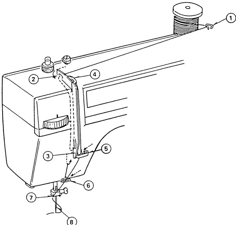
Поворачивая маховое колесо в направлении к себе, поднять нитепрятягивательный рычаг.
