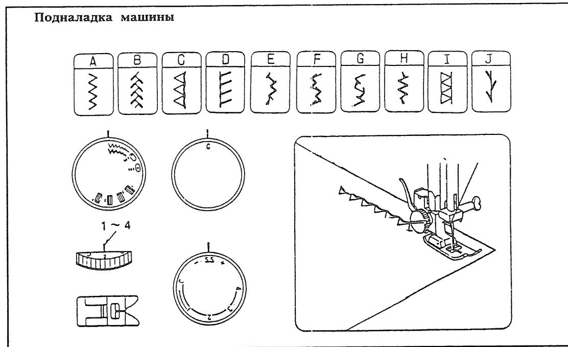
В случае, если не балансируются подачи ткани вперед и назад в зависимости от вида ткани, надо корректировать баланс, поворачивая ручку регулировки длины стежком:
