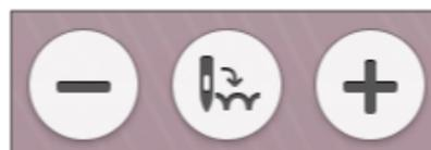
Чтобы перейти к конкретному стежку в пределах цветовой блока, нажмите кнопку **Переход по стежкам** и введите номер стежка. Если номер слишком большой, машина автоматически перейдет к последнему стежку в данном цветовом блоке.
