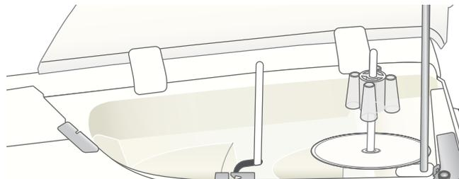
1. Поднимите оба катушкодержателя в вертикальное положение. Установите катушки на оба держателя.
