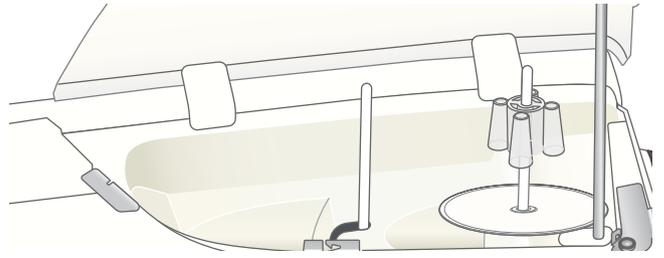
1. Установите катушку на дополнительный катушкодержатель
