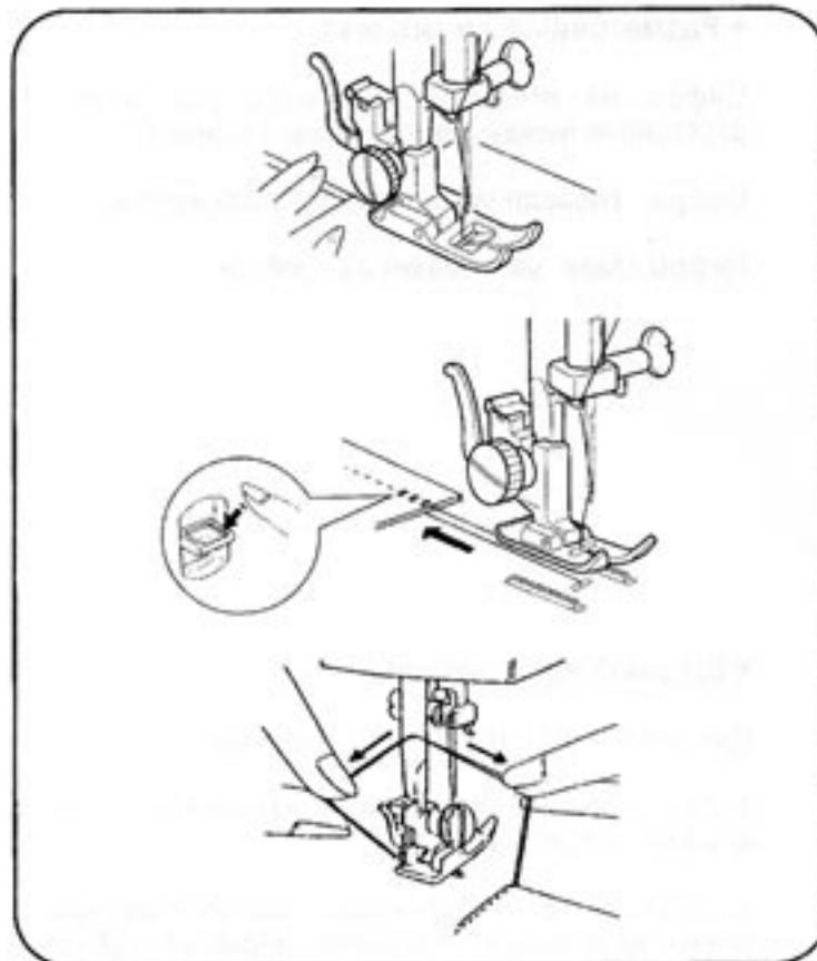
Поднимите прижимную лапку и расположите ткань рядом с разметочной линией на игольной пластинке. Опустите иглу в ткань. Опустите прижимную лапку и расправьте нити назад. Нажмите на ножной привод.
