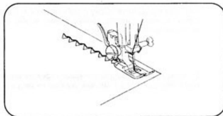
Если прямая и обратная подача будут разбалансированы, в зависимости от типа ткани исправьте балансировку вращением ручки установки длины стежка следующим способом:
