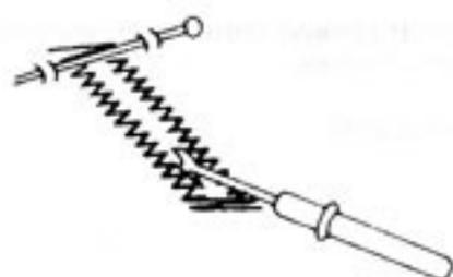
Установите ручку выбора стежка в положение "0" и прострочите 5 стежков закрепки, поднимите иглу от ткани.
