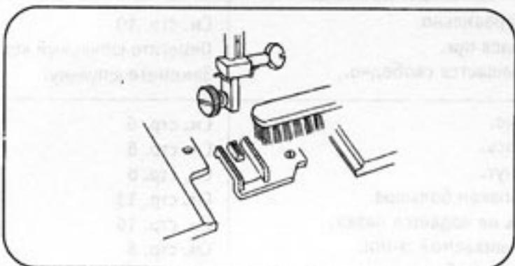
С помощью щетки очистите пыль и пух, закупоривающий подающую зубчатку.
