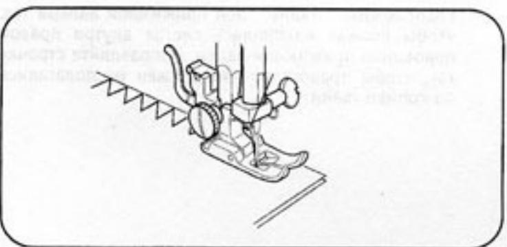
Оверлочным стежком обрабатывают припуски на швы для предотвращения сборок необработанного края.
