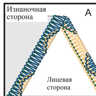
1. Переместите рычаг селектора волны из положения "Overlock" в положение "Wave".
