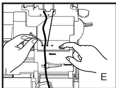
8. Пропустите нить верхнего петлителя под лапку и отведите нить влево, отрежьте конец нити нижнего петлителя длиной 10 см и оставьте его висеть свободно. Отрежьте нить цепочного петлителя длиной 10 см и оставьте ее на поддоне. Закройте боковую дверцу машины (рис. G). Закройте боковую дверку, крышку режущей пластины и переднюю крышку машины.
