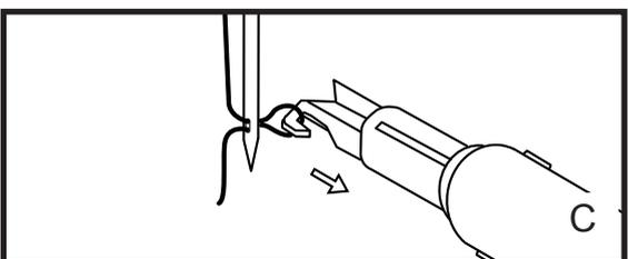
3. Используя крючок на кончике нитевдевателя или пинцет вытяните нить с задней стороны иглы, расположив нить под лапкой (рис. С)
