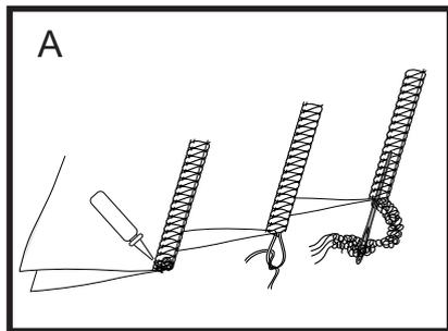
Строчка данной машины легко не распускается, и в большинстве случаев прошитые швы закрепляются пересекающим швом.
