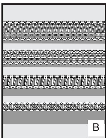
Ширина стежка плавно меняется в пределах каждого диапазона. Нужно просто повернуть головку, совместив требуемое число с указателем на машине. Используйте более широкий стежок для свободных тканей. Более узкий стежок предпочтителен для трикотажных, обычных плотных или прозрачных тканей (рис. В).
