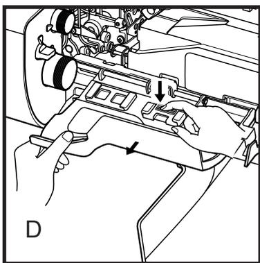
Чтобы использовать швейный стол для выполнения закрывающей цепной строчки, необходимо заменить крышку режущего лезвия, выполнив следующие действия:
