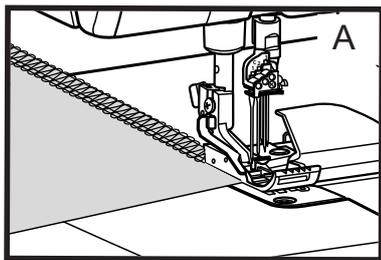
1. Шейте вдоль одной кромки, пока не дойдете до угла. Сделайте один стежок за краем ткани (рис. А). (При приближении к краю можно остановиться и вручную повернуть маховик на себя).
