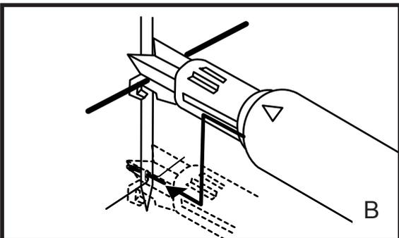
2. Прижмите нитевдеватель к игле и сдвиньте его вниз по канавке в игле до ушка. Слегка надавите на нитевдеватель, чтобы протолкнуть нить в Ушко иглы. Затем перестаньте давить на нитевдеватель, оставляя нить в ушке иглы (рис. В).
