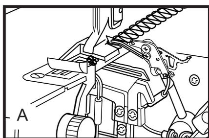
При шитье на данной машине можно видеть, что движение ниток по ткани отличается от обычного шитья, так как происходит оно по нитеводителям строчки (строчечным пальцам) (рис. А).
