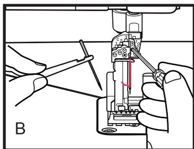
Для перехода машины на широкий 3-ниточный широкий оверлочный шов (5,5-7,5 мм), отрежьте нитку иглы O-2 выше игольного ушка (рис. А). Снимите иглу O-2 и освободите машину от ее ниток полностью. Слегка затяните зажимной винт иглы, чтобы предотвратить его выпадение от вибрации (рис. В).
