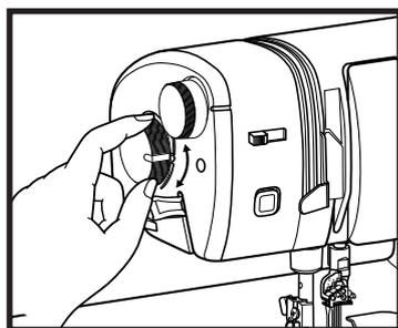
Усилие прижимной лапки заранее установлено на заводе и редко нуждается в регулировке. Тем не менее, чтобы получить равномерную подачу под прижимной лапкой, может возникнуть необходимость уменьшения усилия для толстых тканей и увеличения при использовании тонких тканей. Поверните регулировочный диск в левую сторону машины. Для увеличения усилия, поверните регулировочный диск против часовой стрелки. Для уменьшения - поверните его по часовой стрелке.
