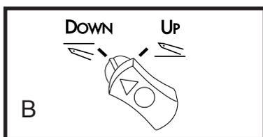
При переходе от оверлочного шва на цепочную или закрывающую строчку следует также переместить рычаг установки верхнего петлителя в нижнее положение DOWN перед тем как закрыть дверцу швейного столика.
