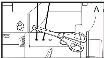
Любая нить иглы может быть задействована для двухниточного оверлочного шитья.
