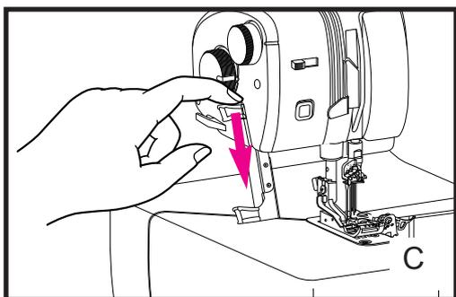
7. Установите рычаг переключателя устройства подачи нити иглы в положение Chain (Cover) (Цепное (закрывающие строчки)) или Over Lock (оверлок) в зависимости от потребностей (рис. E).
