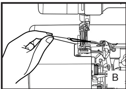
1. Откройте переднюю крышку и поднимите прижимную лапку.
