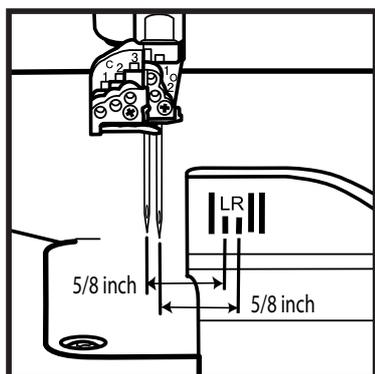
1. Цепочная строчка (С-3) в сочетании с 3-ниточной оверлочной строчкой является наиболее распространенной 5-ниточной комбинацией. Метка, наиболее близкая к иглам, соответствует расстоянию 16 мм от обрезаемой кромки до цепочной иглы С-3.
