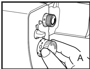
Головка регулировки длины стежка удобно расположена слева от передней крышки у основной платины (рис. А). Головка имеет два диапазона длины стежка от 0,75 мм для самого короткого стежка, до 4 мм для самого длинного. На головке один из диапазонов относится к стандартному шитью, другой к ролевым подрубочным или к узким подрубочным швам.
