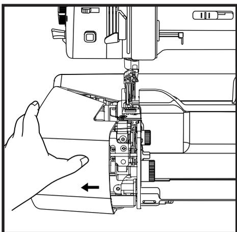
Откройте боковую дверцу слева для облегчения доступа к поддону петлителя цепочной нити. Закройте дверцу перед шитьем.
