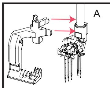
Данное устройство разработано для устранения проблем, связанных с расположением нити в ушке иглы, при использовании воздушной системы машины для подачи нити на иглы.
