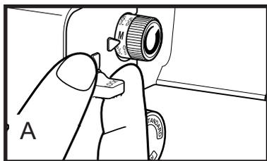
Чтобы заблокировать режущее лезвие в нижнем положении: Поверните головку на 180 градусов по часовой стрелке, чтобы отметка блокирования LOCK оказалась сверху. Режущее лезвие останется под игольной пластиной для приемов шитья без обрезания кромки (рис. А).
