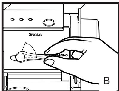
3. В заблокированном положении машины (рис. В) установите заправочное отверстие петлителя U, L или С соответственно заправляемому петлителю.
