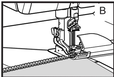
**Примечание:** Свободная нитяная петля в углу ткани вызывается чрезмерным провисанием игольной нити, получившимся при освобождении строчечных пальцев. Сделайте повторную попытку, обход углов требует некоторого опыта!
