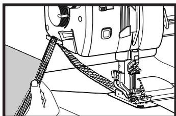
Нитеобрезатель расположен с левой стороны машины Gloria. В конце шва выйдете за край ткани и продолжайте шить, чтобы получилась нитяная цепочка длиной 12,5-15 см. Поднимите нитяную цепочку вверх и проведите ее через нитеобрезатель с задней стороны вперед.
