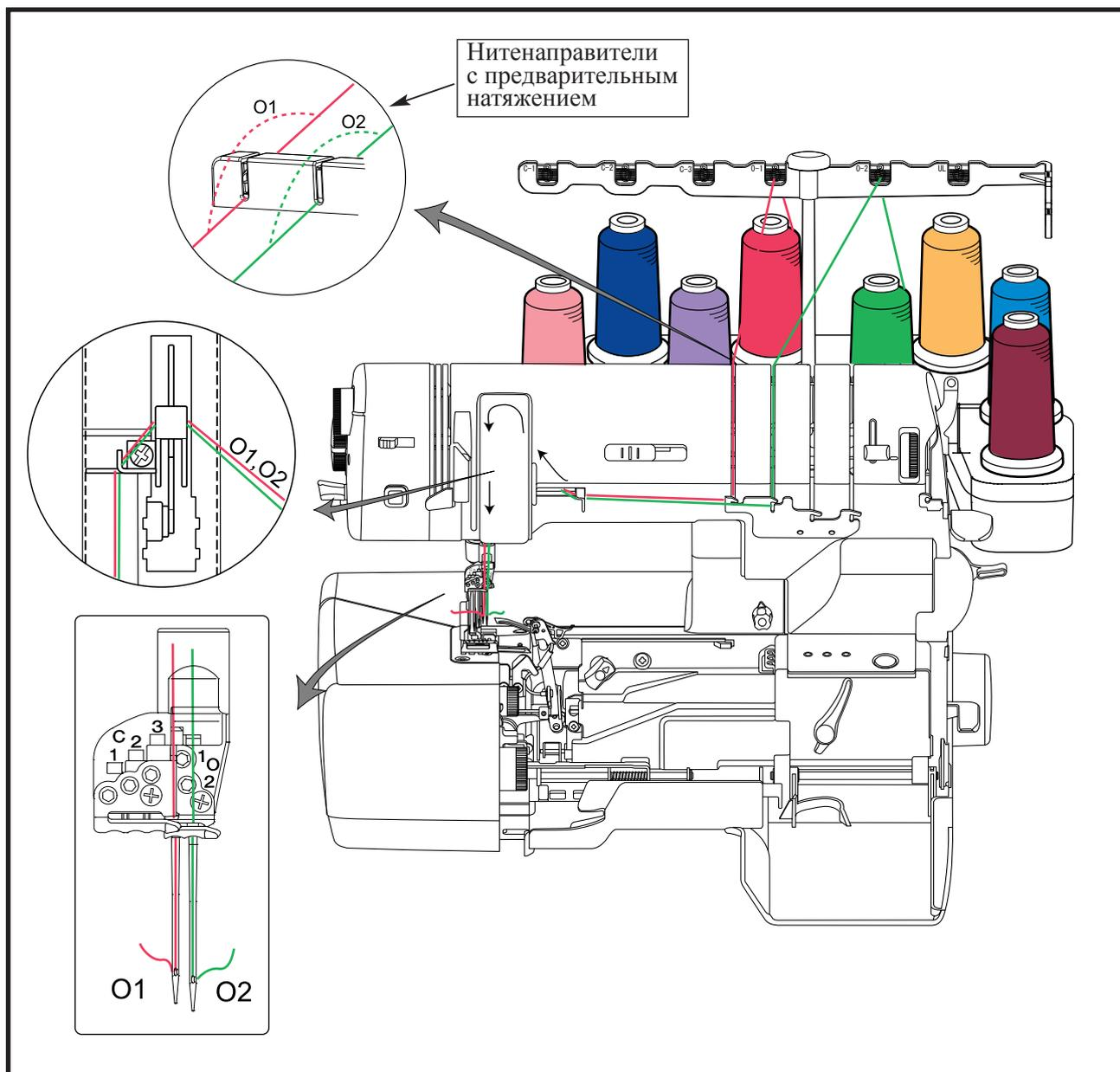
Каким образом использовать устройство подачи иглы с помощью оборотного воздуха
