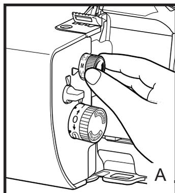
Головка регулировки ширины стежка расположена над головкой длины стежка (рис. А). Головка ширины стежка имеет два диапазона чисел, отвечающие двум диапазонам ширины стежка для оверлочных строчек. Большие числа с каждого края головки, 5,5 и 7,5 мм, означают ширину стежка при использовании иглы 0-1 (левая игла). Меньшие числа, 3,0 и 5,0 мм, применяются только при использовании иглы 0-2 (правая игла) для формирования 3-ниточной строчки. Положение «М» (3,5) - для ролевого подрубочного шва.
