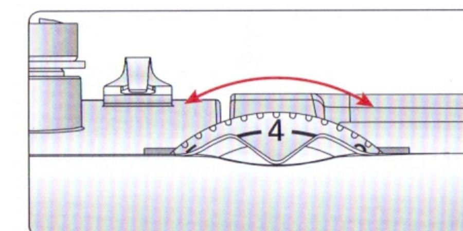
Правильное натяжение верхней нити обеспечивает хороший вид и прочность шва. Обычно верхняя и нижняя нить переплетаются в середине между слоями ткани (A).
