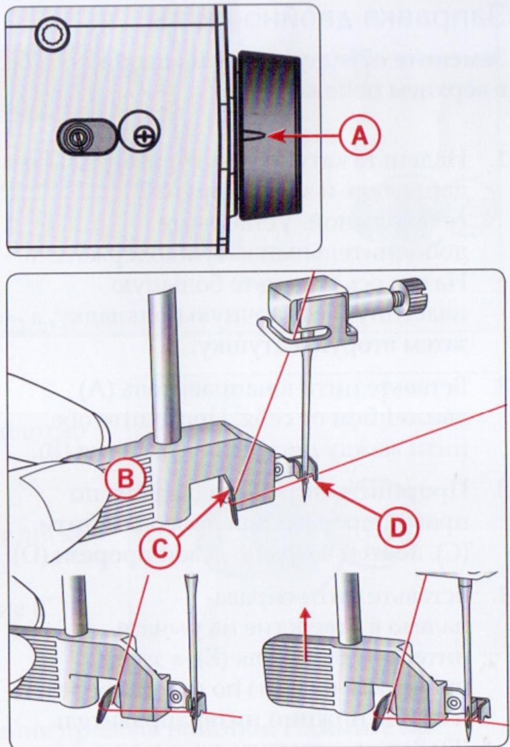
**Важно:** Нитевдеватель сконструирован для заправки игл размеров 70-120. Нельзя использовать его для заправки нити в иглы меньшего размера (например 60), а также игл с лопастью и двойных игл.
