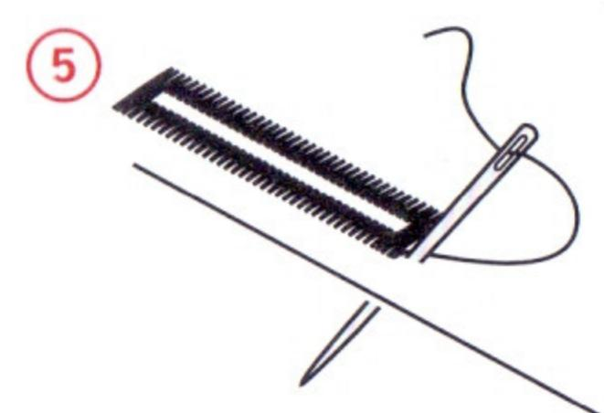
Используя прорезатель из комплекта машины, аккуратно прорежьте петлю от краев к середине.
