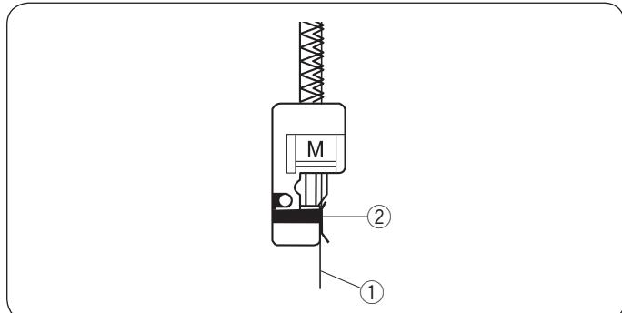
Этот стежок замечательно подходит для тканей, которые могут осыпаться, таких как лен и габардин. Два ряда стежков зигзагообразной строчки, одновременно прошитых поверх края, обеспечивают защиту ткани от осыпания. Расположите край ткани рядом с разметочной линией на лапке и затем прострочите.
