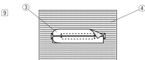
9 Нашивку следует обрезать на расстоянии 1–1,5 см (7/16–5/8 дюйма) от отверстия. Углы следует обрезать с закруглением, как показано на рисунке.
