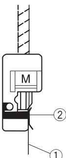
Этот стежок рекомендуется использовать для сшивания таких тканей, как синтетические трикотажные ткани и эластичный велюр, т. к. он обеспечивает самую высокую степень эластичности и прочности.
