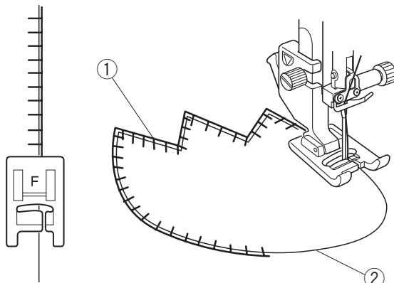
Расположите аппликацию на ткани и приметайте ее или используйте булавки, чтобы закрепить аппликацию.
