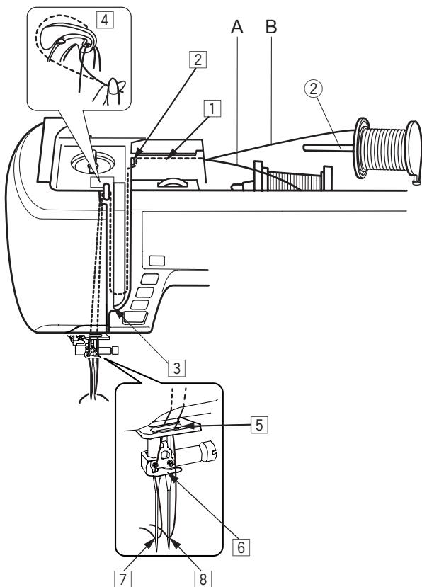
Вставьте дополнительный катушечный стержень в отверстие рядом с горизонтальным стержнем катушки.
