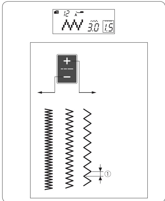
Стежок зигзаг используется при различных техниках шитья, включая сшивание через край. Его можно применять для большинства вязаных тканей.
