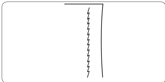
Эта узкая эластичная строчка предназначена для предотвращения растяжения и сокращения трикотажных материалов и при шитье по косой, когда шов нужно разутюжить.
