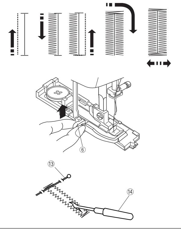
⑥ Петля выполняется автоматически в порядке, показанном на рисунке. Когда петля будет готова, машина автоматически остановится с иглой в верхнем положении. Нажмите кнопку обрезки нити и удалите ткань.
