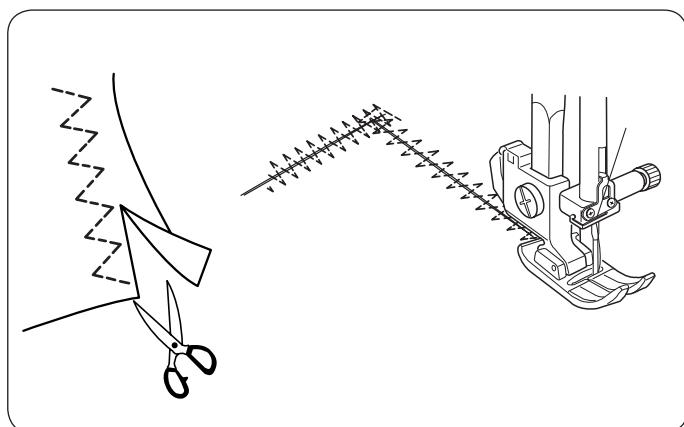
Эта строчка применяется для обработки края синтетических и других эластичных тканей, которые склонны к образованию складок. Шейте вдоль края ткани, оставляя небольшой припуск на обрезку. По окончании шитья, обрежьте припуск близко к строчке.
