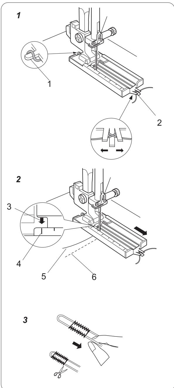
**1** Поднимите лапку для петли, набросьте шнур на крючок сзади лапки. Переведите концы шнура вперед, заправив под лапку. Зашептите шнур в вилке впереди лапки, чтобы натянуть его.
