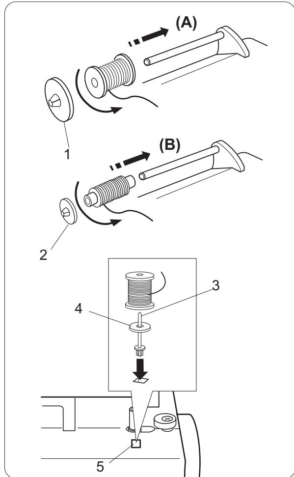
**Установка катушки на катушкодержатель**
