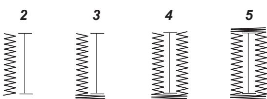
**3** Поднимите иглу в верхнее положение и установите ручку выбора строчек на “”. Прошейте 5 стежков. Остановите машину на правом стежке.
