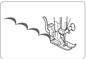
При шитье на деликатных тканях, таких как шифон, при необходимости используйте однослойную подкладку с отрывной основой.
