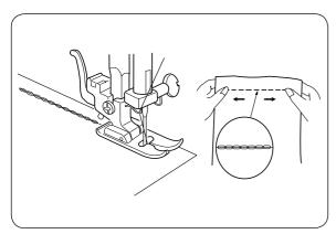
Этот прочный эластичный стежок рекомендуется применять там, где для обеспечения комфорта и прочности необходимы как эластичность, так и прочность.
