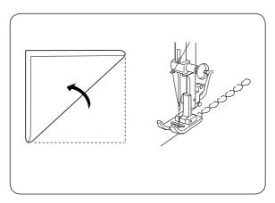
Используйте тонкую ткань (например, трикотаж). Сложите и прострочите по косой линии. Если игла отклоняется вправо, дайте ей лишь слегка коснуться сложенного края ткани. После шитья раскройте ткань и загладьте складки на одну сторону.
